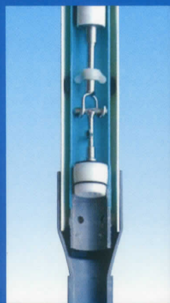
২১। গাইড রড (চালিকা দন্ড) এভাবে আক্রান্ত মধ্য আটকে থাকবে। এবার ডান মোচড়ে রেখে আস্তে আস্তে সম্পূর্ণ পাম্পরডগুলি তুলে ফেলুন।
